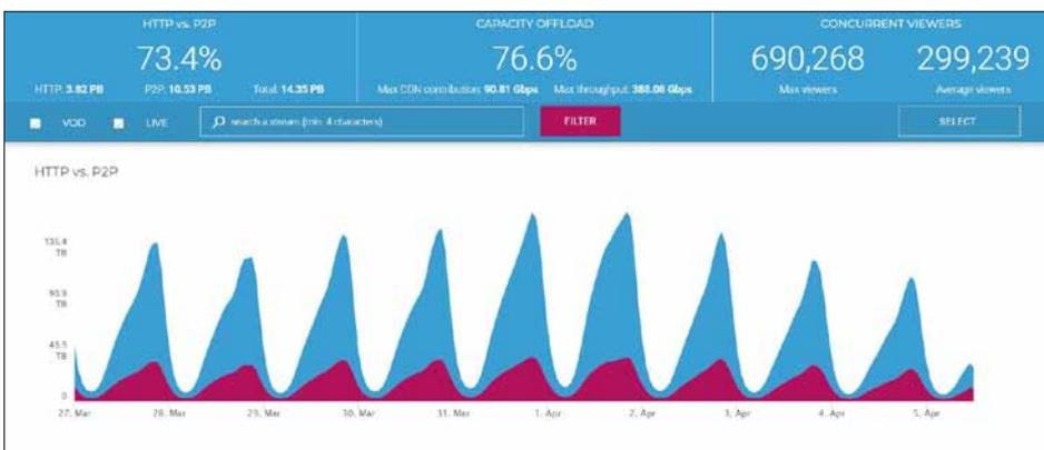
Courbe de suivi d'un flux vidéo géré par la solution Streamroot : en moyenne 73,4 % du trafic emprunte le réseau distribué en ptp.
