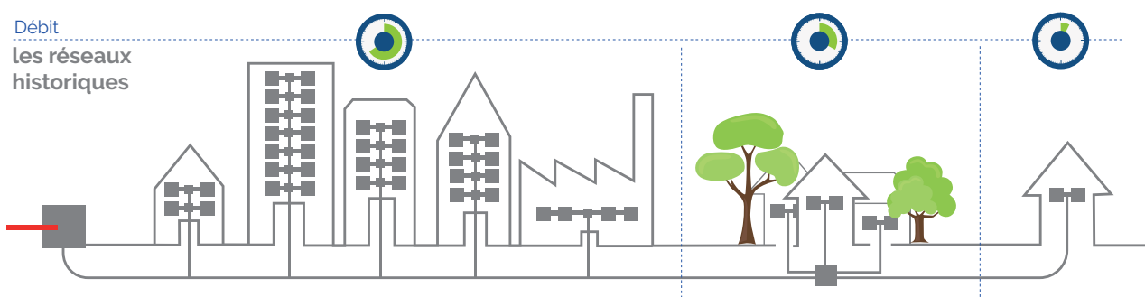
Fig. 08 | Le débit est lié à la distance existant entre le NRA et le client final
