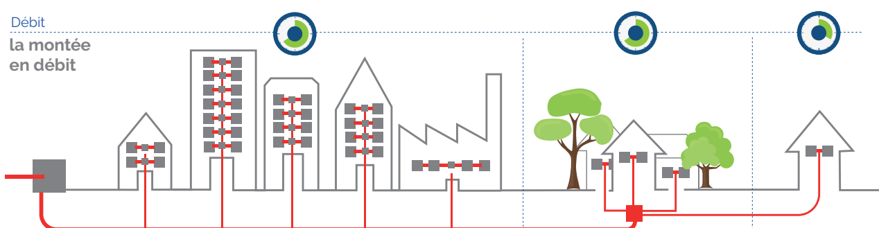
Fig. 10 | la fibre de bout en bout, la solution à l'accès au THD pour tous
