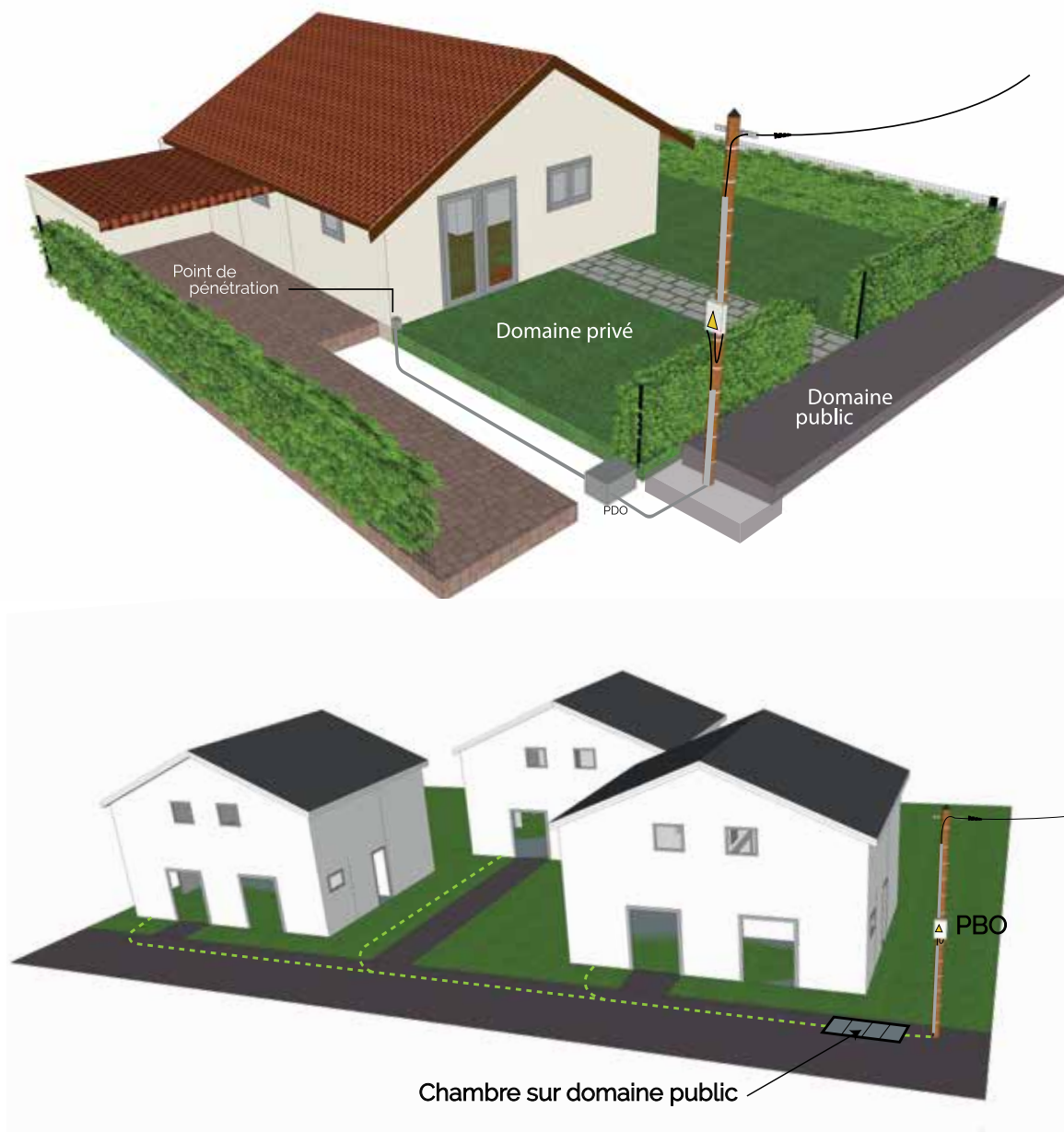
Fig. 38 | Cas d'un branchement aéro-souterrain
