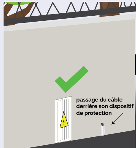
Fig. 21 | Cas d'une colonne rampante extérieure conforme
